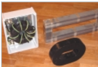
Sugtransformatorer reducerar magnetfält.
